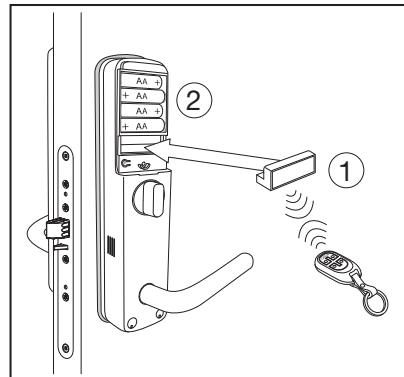
Vid installation av fjärrkontroll se till att mottagaren sätts i låsets insida före batterierna.
